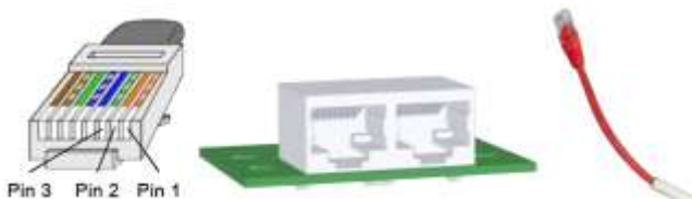
Pav. 3: RJ45 magistralė kabelio kištukas, RJ45 lizdinės jungties įtaisas ir galinis rezistorius (R)
