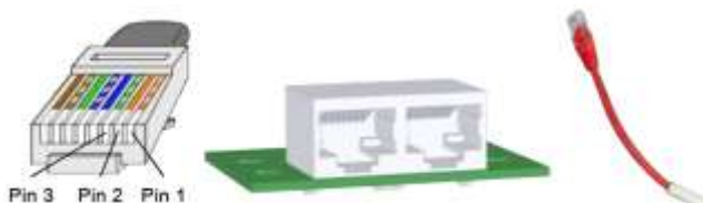
Abb. 3: RJ45 Stecker Buskabel, RJ45 Buchsen Gerät und Abschlusswiderstand (R)
