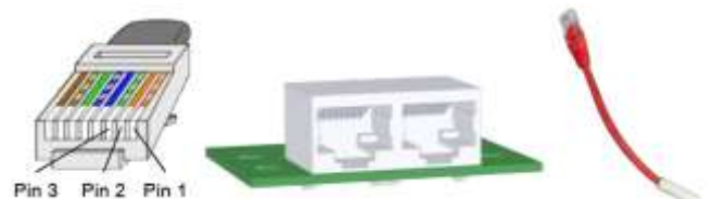
Kuva 3: RJ45-pistoke väyläkaapelissa, RJ45-pistoholkki laitteessa ja päätevastu (R)
