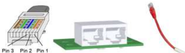
Sl. 3: Sabirnički kabel sa RJ45 utikačem, uređaj sa RJ45 utičnicom i završni otpornik (R)
